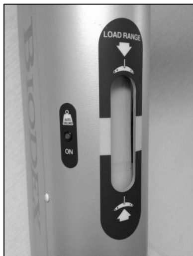
Figure 3.9. La balance de poids à alléger se trouve sur la colonne principale.
