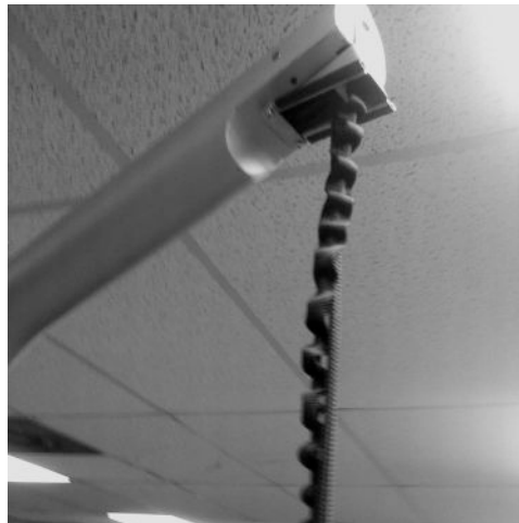
Abbildung 3.8. Anbringung des Sicherungsseils (geriffeltes elastisches Seil) in der Mitte der Patientengurtstange.
