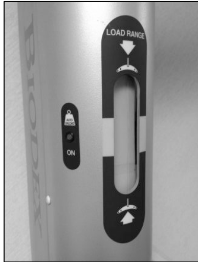
Abbildung 3.9. Die Entlastungskraftbereichsskala befindet sich auf der Hauptsäule.
