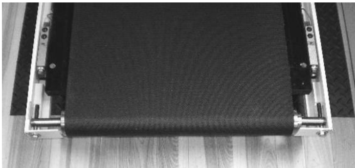
Figura 9.10. Pernos hexagonales para ajustar la cinta hacia la izquierda o hacia la derecha.
