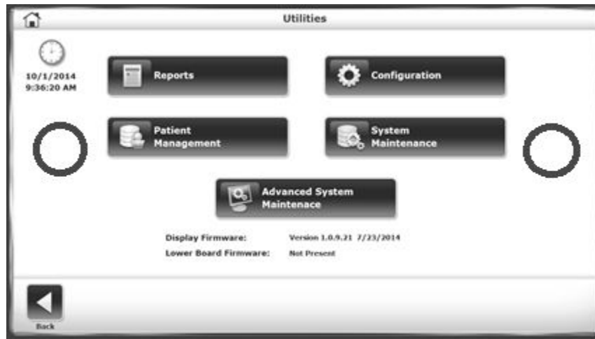
Figura 9.2. Menú principal, seguido de toques derecha-izquierda-derecha para activar el botón Advanced System Maintenance (Mantenimiento avanzado del sistema).
