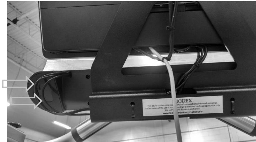
Figura 8.3. Cables de alimentación y sonido de la barra de sonido (flechas).
